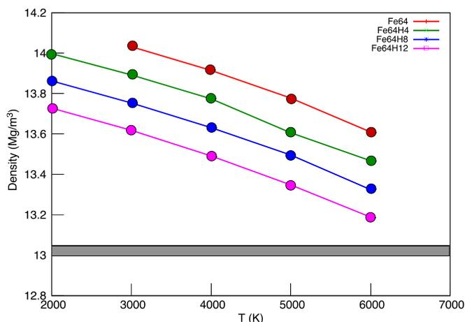
図1: 360GPa で計算した固体鉄水素合金の密度。灰色の部分、地震波測定によって得られている内核の密度を示している。
