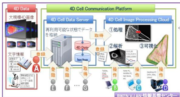
4D Cell Data Server から 4D Data を rsync で定期的に RICC 高速ストレージに転送しバックアップされる、システムの信頼性を高めた。
