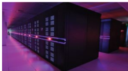
Xeon Ivy 12 コア × 2 + Xeon Phi 57コア × 3 =195core/node
